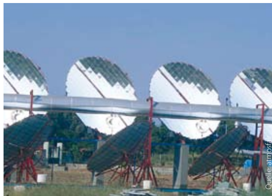
Indien: Solarspiegel für die Dampferzeugung
