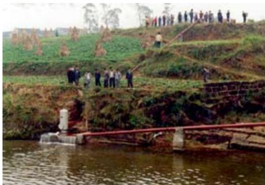
Durch das Fallrohr rechts unten strömt Wasser, das durch das Steigrohr in der Mitte hochgepumpt wird
