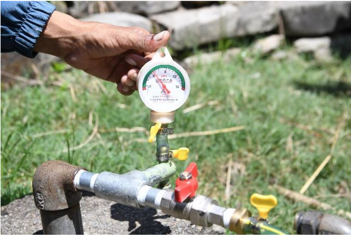
Abbildung 10: NBPA-Techniker überprüft Dichtigkeit des Leitungssystems
